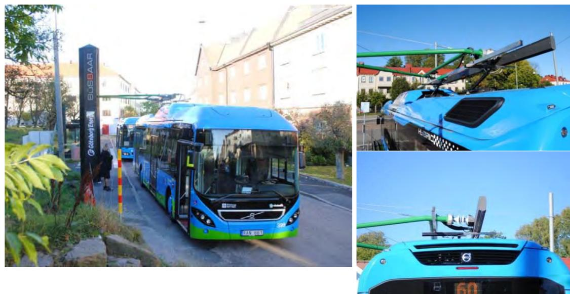
Figure 7 : Véhicule et structure de recharge du projet HyperBus à Göteborg
