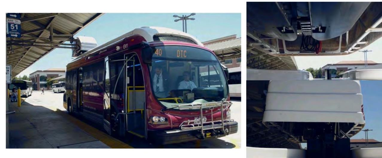
Figure 10 : Système de recharge Proterra à Denver, CO
