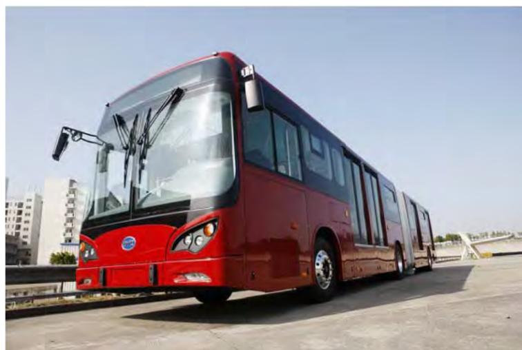
Figure 8 : Autobus articulé 18 m à recharge lente BYD pour SRB
