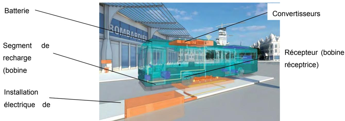
Figure 4 : Vue « rayon X » d'un système par induction Primove™
