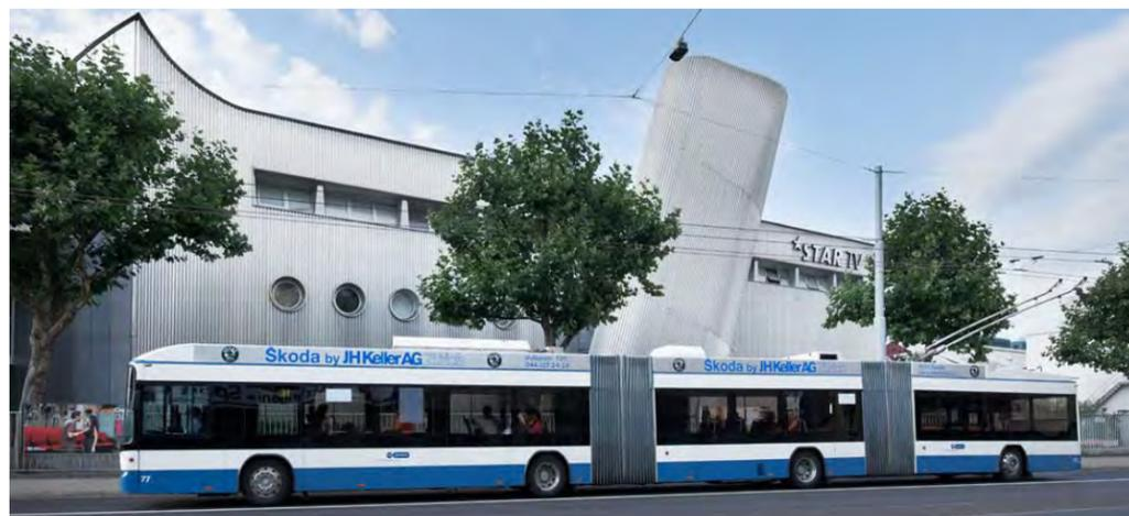
Figure 15 : Trolleybus bi-articulé
